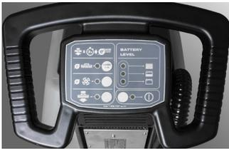
Interrupteur marche/arrêt qui empêche les allumages accidentels. Protection contre les surcharges, la décharge excessive de la batterie (modèles à batterie uniquement) et l'utilisation accidentelle. Commande pratique pour le démontage/entretien de la brosse. Réglage Eco Energy pour une utilisation prolongée et un fonctionnement extrêmement silencieux (modèles à batterie uniquement).
